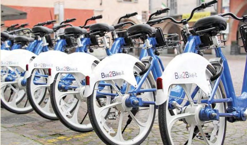
Telaio in alluminio, sella regolabile, cerchi in lega e pneumatico solido a prova di esplosione: sono le caratteristiche delle bici a pedalata assistita del nuovo servizio [Foto: Bus Company]
