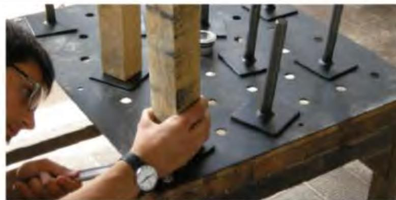
Fig. 3 Particolare della piastra di ancoraggio degli elementi bosco
