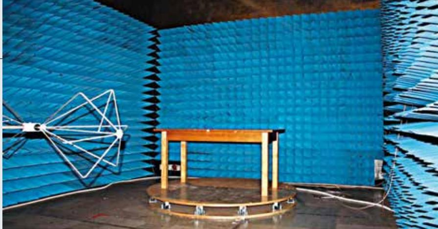
Prove di compatibilità elettromagnetica (EMC) in accordo alle direttive e secondo le norme UE [Foto: Tecnolab]
