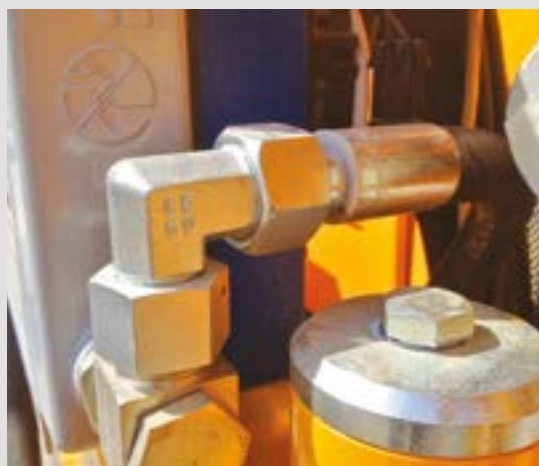
Alcuni particolari dei raccordi per alte pressioni realizzati in acciaio inox e carbonio dalla Cast Spa [Foto: Cast Spa]
